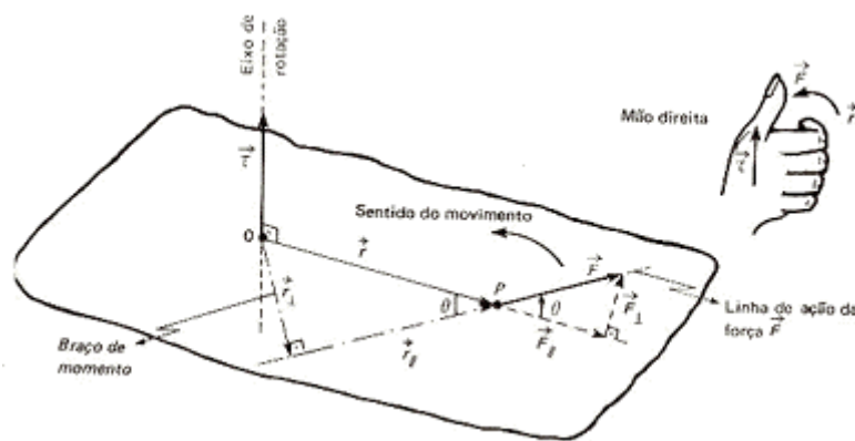
Figura 2.12 - Determinação pela regra da mão direita do sentido do momento da força F aplicada no ponto P .
